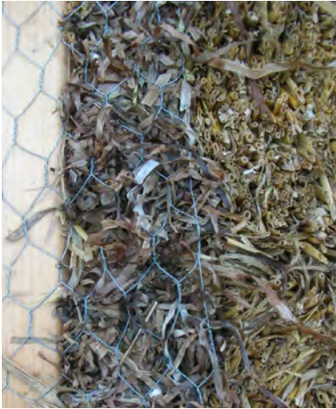
Diffusionsåben fornybar isolering med halm og ålegræs
